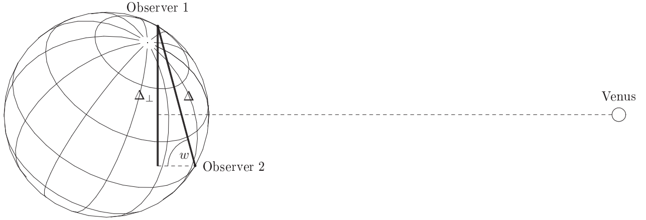
Abbildung 10: Für die Bestimmung der Sonnenparallaxe kommt es nicht auf den Abstand \Delta der beiden Beobachter an, sondern auf dessen Projektion \Delta_{\perp} parallel zur Richtung zur Venus.
